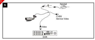
Schließen Sie entweder das Videokabel mit dem gelben oder mit dem grünen BNC-Stecker an ein geeignetes Gerät an (DVR/Recorder, Monitor).
