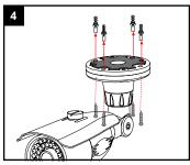
Verwenden Sie die mitgelieferten Dübel und Schrauben, um die Kamera zu befestigen.
