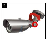
Richten Sie die Kamera in die gewünschte Blickrichtung aus. Ziehen Sie die Schraube und die Verschraubung anschließend wieder fest.
