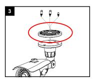
Die schwarze der Montageplatte Dichtungsmatte muss nach Außen von der Kamera weg gerichtet sein.
